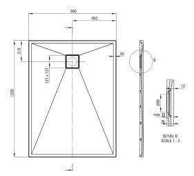
Tolerancja wymiarów  $\pm5\%$  dla wartości do 200 mm i $\pm3\%$  dla wartości powyżej 200 mm All dimensions in mm tolerance  $\pm5\%$  for below 200 mm and  $\pm3\%$  for above 200 mm
