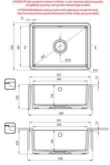
Tolerancja wymiarów  $\pm 5\%$  dla wartości do 200 mm i  $\pm 3\%$  dla wartości powyżej 200 mm All dimensions in mm tolerance  $\pm 5\%$  for below 200 mm and  $\pm 3\%$  for above 200 mm
