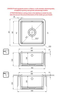
Tolerancja wymiarów  $\pm 5\%$  dla wartości do 200 mm i  $\pm 3\%$  dla wartości powyżej 200 mm All dimensions in mm tolerance  $\pm 5\%$  for below 200 mm and  $\pm 3\%$  for above 200 mm
