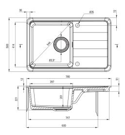
Tolerancja wymiarów ±5% dla wartości do 200 mm i ±3% dla wartości powyżej 200 mm All dimensions in mm tolerance ±5% for below 200 mm and ±3% for above 200 mm
