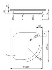
Tolerancja wymiarów  $\pm5\%$ dla wartości do 200 mm i  $\pm3\%$ dla wartości powyżej 200 mm All dimensions in mm tolerance  $\pm5\%$  for below 200 mm and  $\pm3\%$  for above 200 mm
