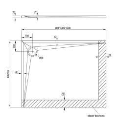
Tolerancja wymiarów  $\pm 5\%$  dla wartości do 200 mm i  $\pm 3\%$  dla wartości powyżej 200 mm All dimensions in mm tolerance  $\pm 5\%$  for below 200 mm and  $\pm 3\%$  for above 200 mm
