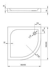
Tolerancja wymiarów  $\pm 5\%$  dla wartości do 200 mm i  $\pm 3\%$  dla wartości powyżej 200 mm All dimensions in mm tolerance  $\pm 5\%$  for below 200 mm and  $\pm 3\%$  for above 200 mm
