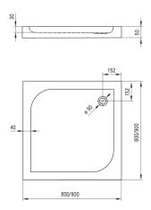
Tolerancja wymiarów  $\pm 5\%$  dla wartości do 200 mm i  $\pm 3\%$  dla wartości powyżej 200 mm All dimensions in mm tolerance  $\pm 5\%$  for below 200 mm and  $\pm 3\%$  for above 200 mm
