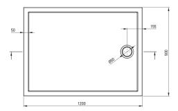
Tolerancja wymiarów  $\pm 5\%$  dla wartości do 200 mm i  $\pm 3\%$  dla wartości powyżej 200 mm All dimensions in mm tolerance  $\pm 5\%$  for below 200 mm and  $\pm 3\%$  for above 200 mm
