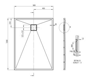
Tolerancja wymiarów  $\pm5\%$  dla wartości do 200 mm i  $\pm3\%$  dla wartości powyżej 200 mm All dimensions in mm tolerance  $\pm5\%$  for below 200 mm and  $\pm3\%$  for above 200 mm
