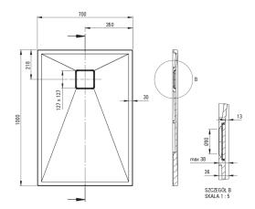
Tolerancja wymiarów  $\pm5\%$  dla wartości do 200 mm i  $\pm3\%$  dla wartości powyżej 200 mm All dimensions in mm tolerance  $\pm5\%$  for below 200 mm and  $\pm3\%$  for above 200 mm
