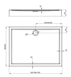
Tolerancja wymiarów  $\pm 5\%$  dla wartości do 200 mm i  $\pm 3\%$  dla wartości powyżej 200 mm All dimensions in mm tolerance  $\pm 5\%$  for below 200 mm and  $\pm 3\%$  for above 200 mm
