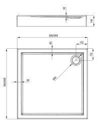
Tolerancja wymiarów  $\pm 5\%$  dla wartości do 200 mm i  $\pm 3\%$  dla wartości powyżej 200 mm All dimensions in mm tolerance  $\pm 5\%$  for below 200 mm and  $\pm 3\%$  for above 200 mm
