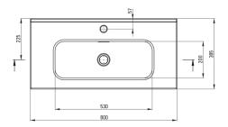
Tolerancja wymiarów  $\pm 5\%$  dla wartości do 200 mm i  $\pm 3\%$  dla wartości powyżej 200 mm All dimensions in mm tolerance  $\pm 5\%$  for below 200 mm and  $\pm 3\%$  for above 200 mm
