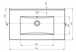
Tolerancja wymiarów ±5% dla wartości do 200 mm i ±3% dla wartości powyżej 200 mm All dimensions in mm tolerance ±5% for below 200 mm and ±3% for above 200 mm
