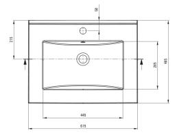
Tolerancja wymiarów ±5% dla wartości do 200 mm i ±3% dla wartości powyżej 200 mm All dimensions in mm tolerance ±5% for below 200 mm and ±3% for above 200 mm
