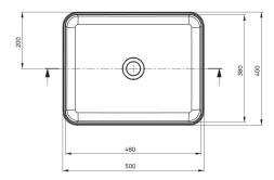
Tolerancja wymiarów ±5% dla wartości do 200 mm i ±3% dla wartości powyżej 200 mm All dimensions in mm tolerance ±5% for below 200 mm and ±3% for above 200 mm
