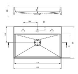
Tolerancja wymiarów  $\pm5\%$  dla wartości do 200 mm i  $\pm3\%$  dla wartości powyżej 200 mm All dimensions in mm tolerance  $\pm5\%$  for below 200 mm and  $\pm3\%$  for above 200 mm
