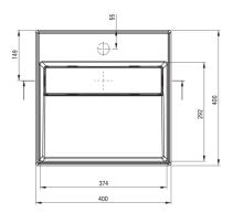
Tolerancja wymiarów ±5% dla wartości do 200 mm i ±3% dla wartości powyżej 200 mm All dimensions in mm tolerance ±5% for below 200 mm and ±3% for above 200 mm
