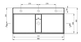
Tolerancja wymiarów ±5% dla wartości do 200 mm i ±3% dla wartości powyżej 200 mm All dimensions in mm tolerance ±5% for below 200 mm and ±3% for above 200 mm
