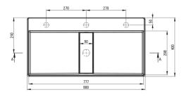
Tolerancja wymiarów  $\pm 5\%$  dla wartości do 200 mm i  $\pm 3\%$  dla wartości powyżej 200 mm All dimensions in mm tolerance  $\pm 5\%$  for below 200 mm and  $\pm 3\%$  for above 200 mm
