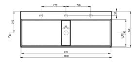
Tolerancja wymiarów  $\pm 5\%$  dla wartości do 200 mm i  $\pm 3\%$  dla wartości powyżej 200 mm All dimensions in mm tolerance  $\pm 5\%$  for below 200 mm and  $\pm 3\%$  for above 200 mm
