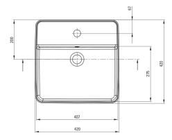
Tolerancja wymiarów ±5% dla wartości do 200 mm i ±3% dla wartości powyżej 200 mm All dimensions in mm tolerance ±5% for below 200 mm and ±3% for above 200 mm
