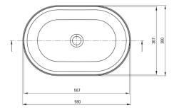
Tolerancja wymiarów ±5% dla wartości do 200 mm i ±3% dla wartości powyżej 200 mm All dimensions in mm tolerance ±5% for below 200 mm and ±3% for above 200 mm
