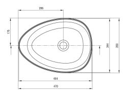
Tolerancja wymiarów  $\pm 5\%$  dla wartości do 200 mm i  $\pm 3\%$  dla wartości powyżej 200 mm All dimensions in mm tolerance  $\pm 5\%$  for below 200 mm and  $\pm 3\%$  for above 200 mm
