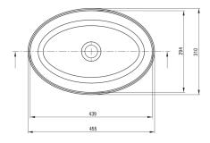
Tolerancja wymiarów  $\pm 5\%$  dla wartości do 200 mm i  $\pm 3\%$  dla wartości powyżej 200 mm All dimensions in mm tolerance  $\pm 5\%$  for below 200 mm and  $\pm 3\%$  for above 200 mm
