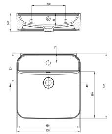
Tolerancja wymiarów  $\pm 5\%$  dla wartości do 200 mm i  $\pm 3\%$  dla wartości powyżej 200 mm All dimensions in mm tolerance  $\pm 5\%$  for below 200 mm and  $\pm 3\%$  for above 200 mm
