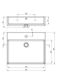
Tolerancja wymiarów ±5% dla wartości do 200 mm i ±3% dla wartości powyżej 200 mm All dimensions in mm tolerance ±5% for below 200 mm and ±3% for above 200 mm
