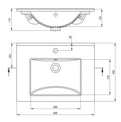
Tolerancja wymiarów  $\pm 5\%$  dla wartości do 200 mm i  $\pm 3\%$  dla wartości powyżej 200 mm All dimensions in mm tolerance  $\pm 5\%$  for below 200 mm and  $\pm 3\%$  for above 200 mm
